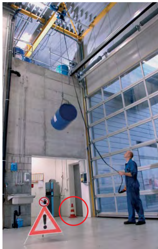
1 Segnalare la zona di pericolo, vietare l'accesso.
