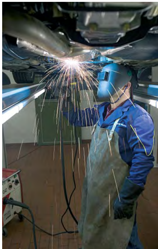
11 Saldatura con equipaggiamento di protezione.
